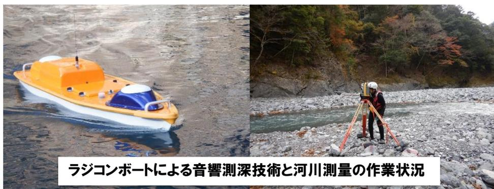
ラジコンボートによる音響測深技術と河川測量の作業状況
